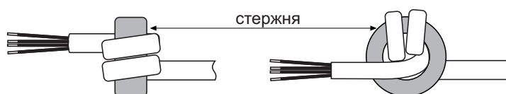
Рис. 9: Монтаж ферритового стержня на проводах
