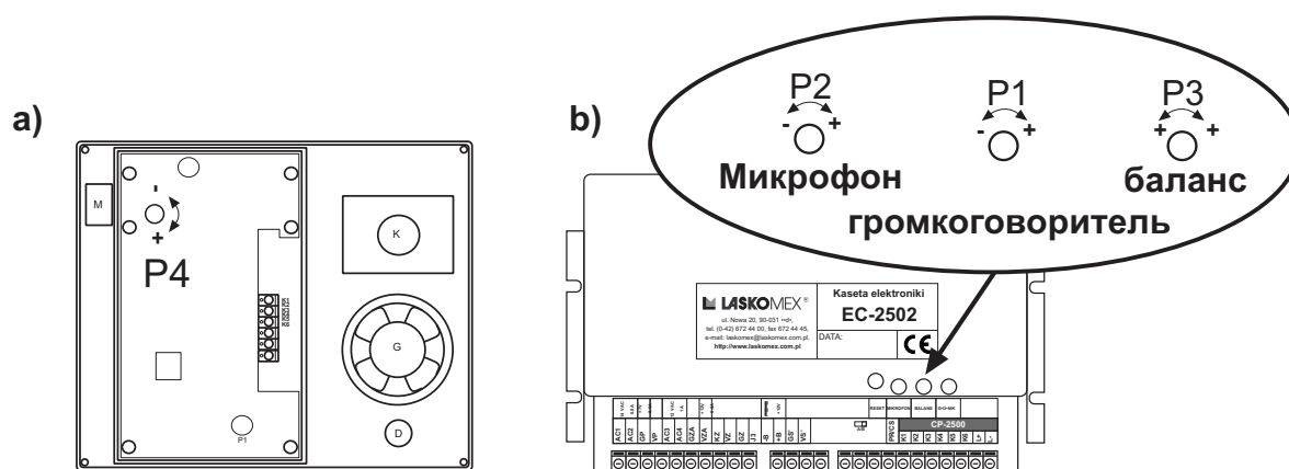
Рис. 15: Регулировочные элементы, а) регулировка усиления микрофона на панели блока вызова, б) регулировочные элементы центрального блока домофона
